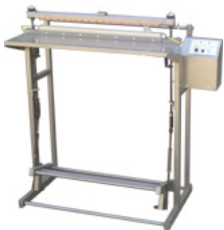
МСН-1000М-2Н - Модификация напольного сварщика МСП-1000М с широким рабочим столом
