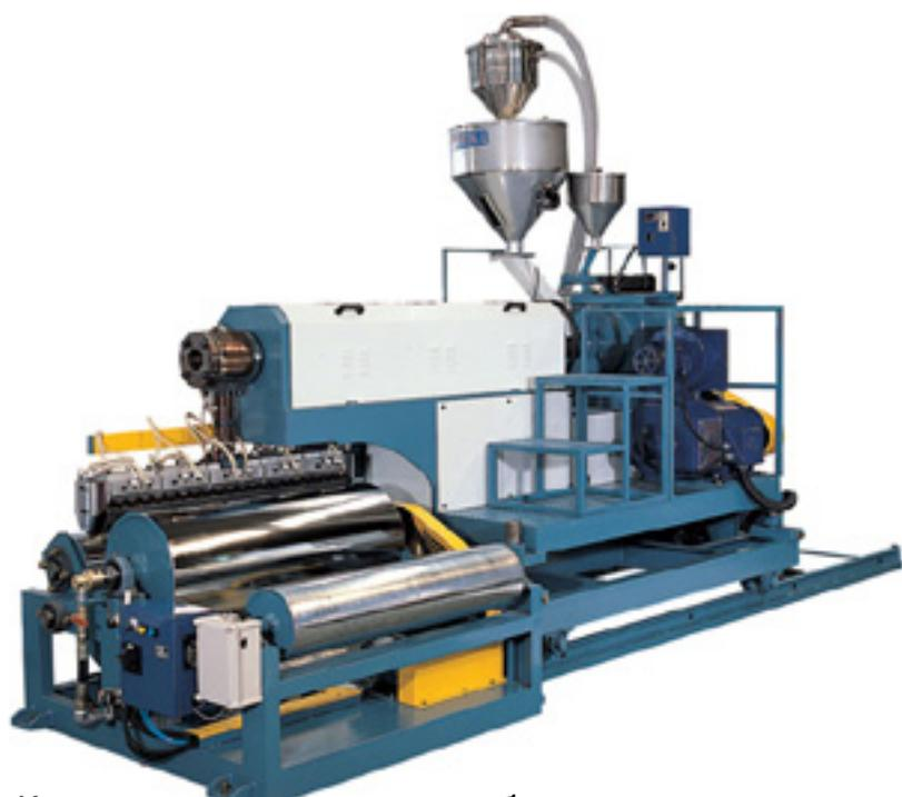
Коатингованная машина может быть установлена в одну производственную линию вместе с экструзионным оборудованием.
