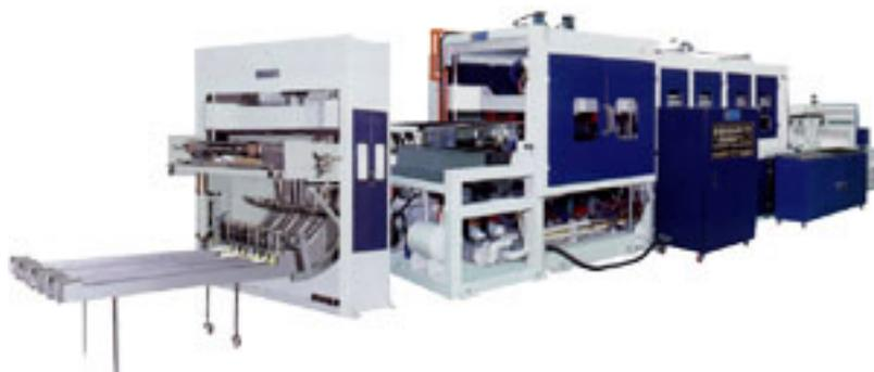
Вакуум-формовочный автомат с автоматическим вырубным прессом применяется для производс
